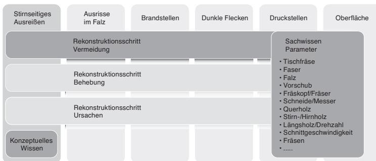
Abb. 4: Darstellung der Analysestruktur des Schadenbildes „Stirnseitiges Ausreißen“ im Rekonstruktionsschritt „Ursachen“ mit einer ausschnittweisen Explizierung der Analyseparameter des „Sachwissens“.
