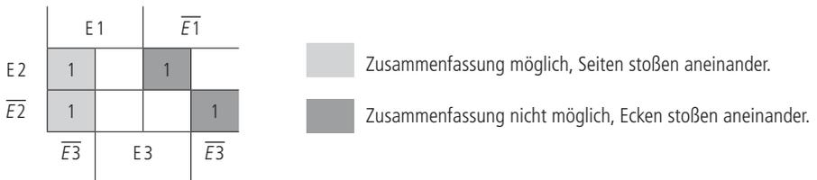
e) Die minimierte Funktionsgleichung wird in einen Logikplan umgewandelt, indem zunächst die UND-Glieder dargestellt werden. Diese sind dann noch durch ODER miteinander zu verknüpfen.
