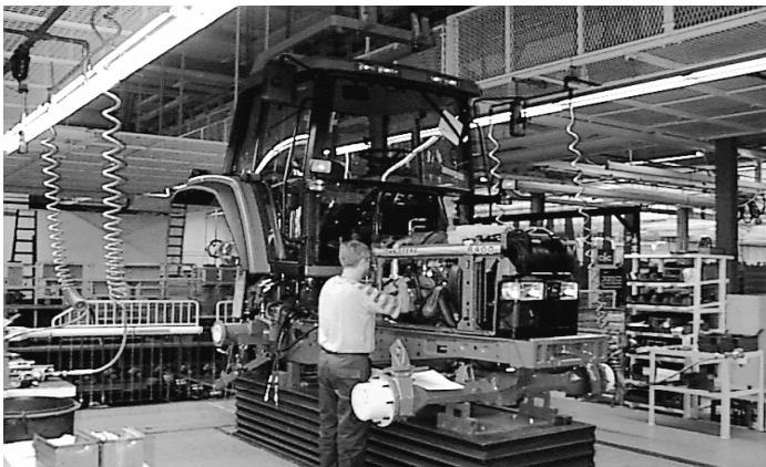
Abb. 4-4: Neues Montagesystem (oben: Einbau des Motors; unten: Montage der Kabine. Gut erkennbar sind die hydraulischen Arbeitsbühnen, im oberen Bild ein-, im unteren ausgefahren)
